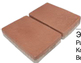
Брук ЭЛЕМЕНТ №3 Размер 115x115x35/45 Кол-во в М2 - 75шт Вес 1м2 - 70/95
